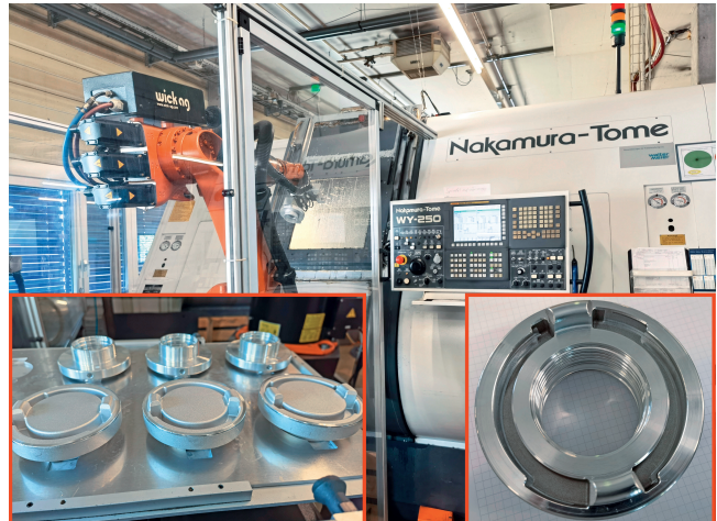
3 Hochpräzise Bearbeitung wassersparender Schlauchkupplungen für Feuerwehr-Hydranten auf einem Drehfräszentrum von Nakamura-Tome. Dank Roboterbeschickung läuft die Fertigung rund um die Uhr © Klaus Vollrath
