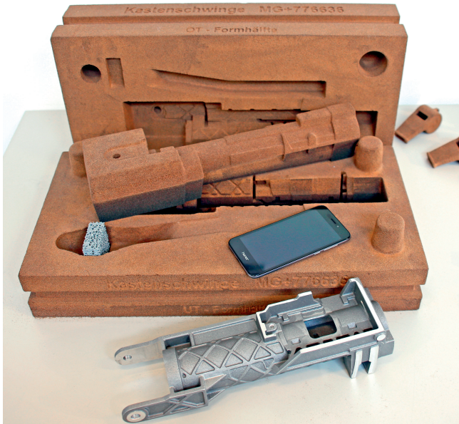
2 Im 3D-Druckverfahren hergestellte Sandform einschließlich Kern sowie das damit im Serienverfahren und aus dem Serienwerkstoff hergestellte Prototyp-Gussteil © Klaus Vollrath
